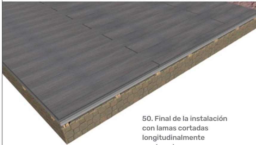
**50. Final de la instalación con lamas cortadas longitudinalmente y colocadas.**
