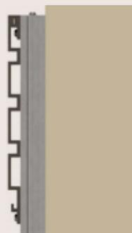
En paneles contiguos, tanto en instalaciones realizadas en vertical como en horizontal, se debe dejar una junta de dilatación de, al menos 6 mm. Esta junta de dilatación es para lamas de hasta 3m. En caso de instalar lamas de una longitud superior, el tamaño de la junta de dilatación deberá ser directamente proporcional a la longitud de la lama.
