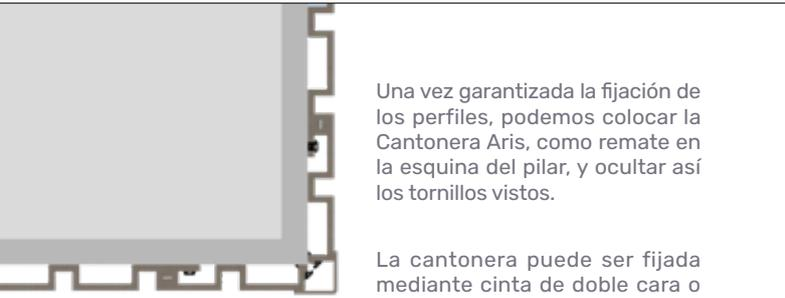
Una vez garantizada la fijación de los perfiles, podemos colocar la Cantonera Aris, como remate en la esquina del pilar, y ocultar así los tornillos vistos.
