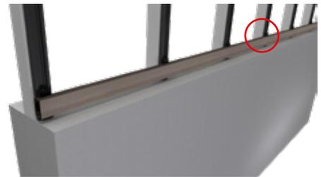
Como ya sabemos, en el clip más centrado de todos y cada uno de los perfiles, colocaremos el tornillo de fijación del clip al perfil Annapurna 50x30 mm. Solo colocamos un tornillo por perfil Annapurna, y la función de este tornillo es evitar que se produzca un desplazamiento lateral de los perfiles, a causa de la dilatación y contracción que pueda sufrir el perfil por las variaciones de temperatura.
