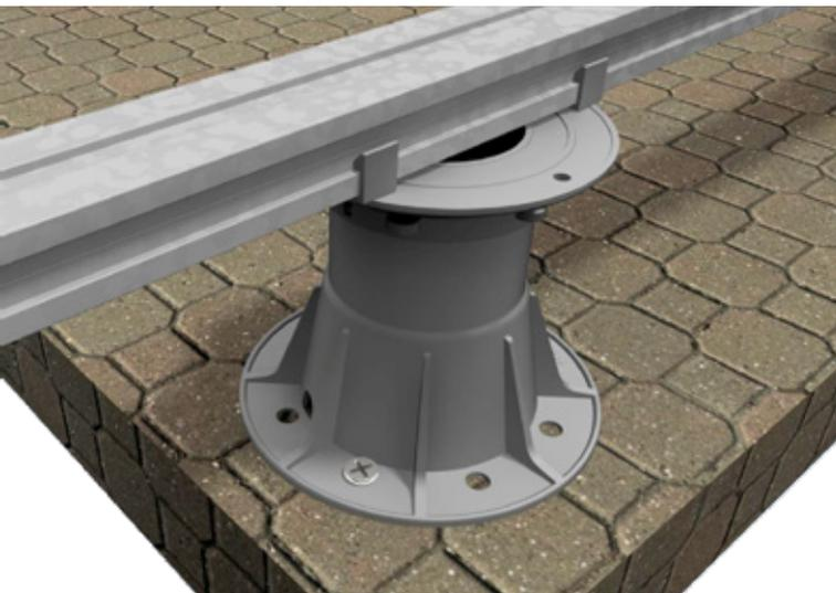
Los plots utilizados en la instalación, al igual que sucede con el rastrel cuando va sobre cuñas, **se deben fijar al suelo** utilizando tornillos de golpeo que penetren, al menos, **35 mm**. **Según la naturaleza del suelo, la Dirección Facultativa de la obra puede modificar el tipo de fijación para garantizar la estabilidad del rastrelado.**
