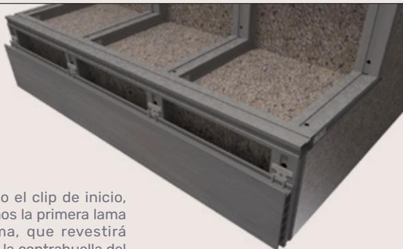
Colocado el clip de inicio, colocamos la primera lama de tarima, que revestirá parte de la contrahuella del peldaño.
