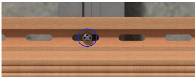
En paneles contiguos, tanto en instalaciones realizadas en vertical como en horizontal, se debe dejar una junta de dilatación de, al menos 6 mm. Esta junta de dilatación es para lamas de hasta 3m. En caso de instalar lamas de una longitud superior, el tamaño de la junta de dilatación deberá ser directamente proporcional a la longitud de la lama.
