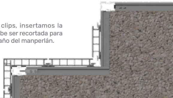
Fijado el manperlán, se colocaría la siguiente tabla para, en este ejemplo, cubrir por completo la huella del primer peldaño. La fijación de esta tabla se realiza también mediante la utilización del clip Tarimatec.
