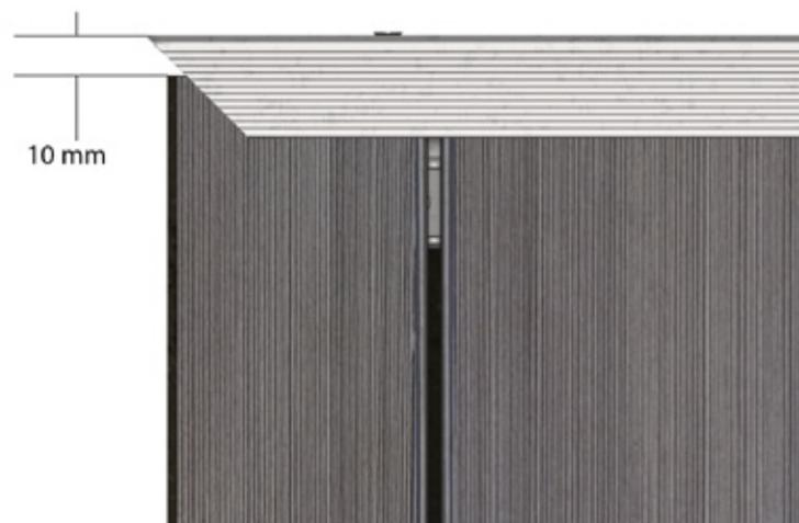
En la siguiente imagen se muestra otro punto de vista de la separación entre la testa de la tarima y la cara interna del perfil F de aluminio.
