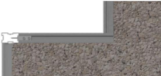
Se instalan del mismo modo que en la primera contrahuella, los rastreles de la segunda, apoyando, como se aprecia en la imagen anterior y la siguiente, sobre los rastreles de la huella del primer peldaño.
