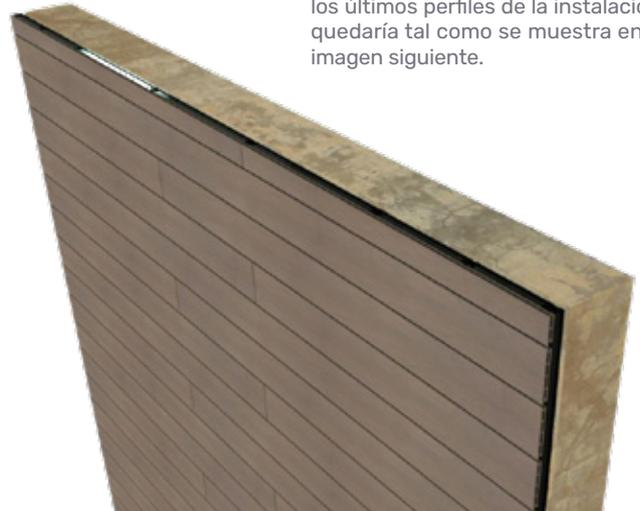
La última fila de perfil Mont Blanc cortado, está fijada al rastrel por su parte inferior mediante el clip Mont Blanc. La parte superior del perfil (que es la cortada) se puede fijar utilizando el perfil de inicio. Para ello cortaremos el perfil de inicio en trozos de 40 mm, y cortaremos tantos como rastreles verticales colocados haya en nuestra instalación.
