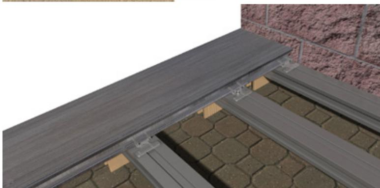
A modo de ejemplo, y para aclarar los conceptos de doble rastrel en zonas de encuentro de testas de tarima, y el rastrel intermedio en los extremos de la instalación, se muestra en la siguiente ilustración, todas las posibilidades de longitud de lama y disposición, según el rastrelado.
