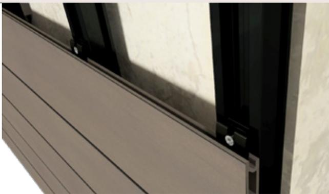
Continuamos colocando perfiles Mont Blanc en las longitudes deseadas para completar las filas restantes hasta finalizar nuestra instalación. Normalmente no ocurrirá que una tabla completa coincida con el fin de nuestra instalación, por lo que tendremos que cortar los perfiles Mont Blanc de la última fila en sentido longitudinal.
