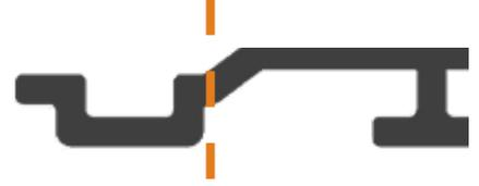
La lama de ARIS Malibú a partir de la cual se ha obtenido el perfil de inicio, se empleará en terminaciones de instalación. Este perfil de inicio, se coloca en el extremo de la instalación para iniciar el montaje de los perfiles.
