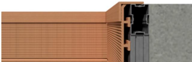
Esta cantonera de remate se fija con tornillo lacado de perfil de remate. La separación entre estos tornillos no debe ser superior a 350 mm.
