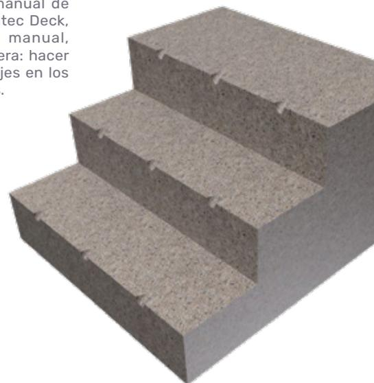
Se coloca el primer rastrel en la contrahuella del primer peldaño. la separación entre rastreles no superior a 350 mm.
